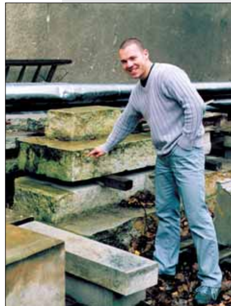
So sieht das Ausgangsmaterial für den Steinmetz oft aus: eine gesägte Sandsteinplatte mit bruchrauen Kanten.
